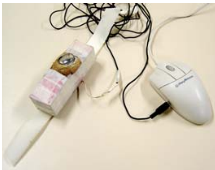
Switch para accionar con la cabeza, hecho con un botón grande de material desechado.
