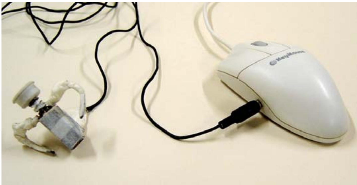
Accionador confeccionado con un botón de encendido / apagado de ordenador.
